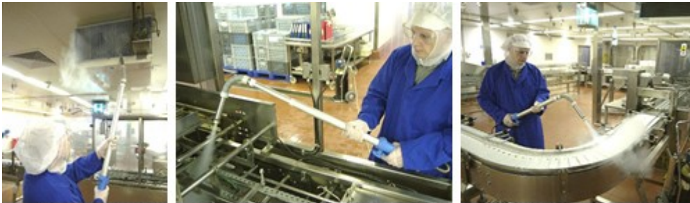
Cryonite permite la aplicación en zonas de difícil acceso así como en zonas sensibles, como aquellas en contacto con alimentos.
